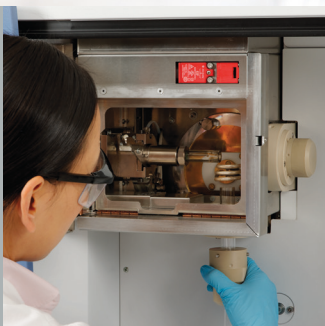
1) Demotujete radiálny horák a interface
