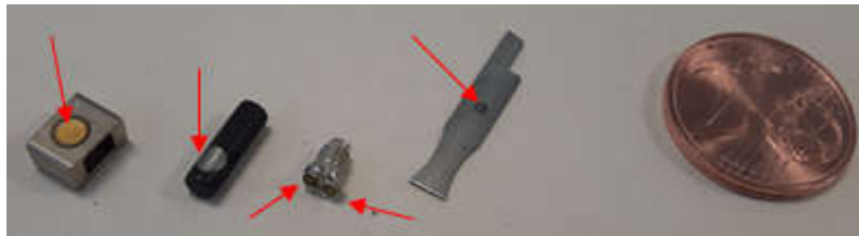
Vzorky s meracími stopami rôznych veľkostí pri 2 centovej minci (18.75 mm priemer) pre porovnanie veľkosti
