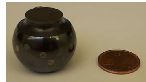
Zakrivená vzorka s meracími miestami v porovnaní s 2 centovou mincou
